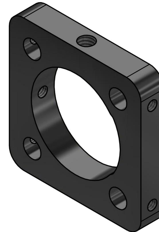
Пластина предназначена для монтажа каркасной системы 30 мм. Имеются отверстия  $\Phi 6$  мм под монтажные стержни RSS-6. Для фиксации стержней предусмотрены резьбовые отверстия M4. Также имеется отверстие  $\Phi 30,48$  мм для установки оптических элементов  $\Phi 1,2$ " или для фиксации оптических тубусов. Для фиксации оптики предусмотрено резьбовое отверстие M4. Отверстия M4 и M6 предназначены для установки на оптическую стойку.
